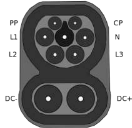
CCS Base combinada AC/DC Tipo 2 en el vehículo. IEC 62196 PE
